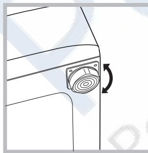
Точная нивелировка обеспечивает стабильность стиральной машины, помогает избежать ее вибраций и смещений в процессе функционирования. В случае установки машины на ковер или ковролин отрегулируйте ножки таким образом, чтобы под стиральной машиной оставался достаточный зазор для вентиляции.
