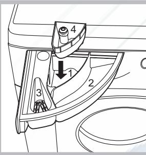
Для осуществления только отбеливания поместите отбеливатель в дополнительный дозатор 4 и задайте программу «Полоскание» и включите функцию «Отбеливание».
